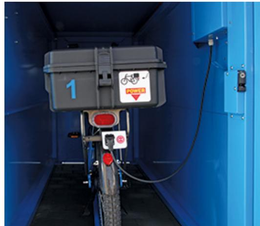
Automatisiertes Pedelec-Verleihsystem mit RFID-Zugang, integrierter Ladetechnik und Flottenmanagement.
